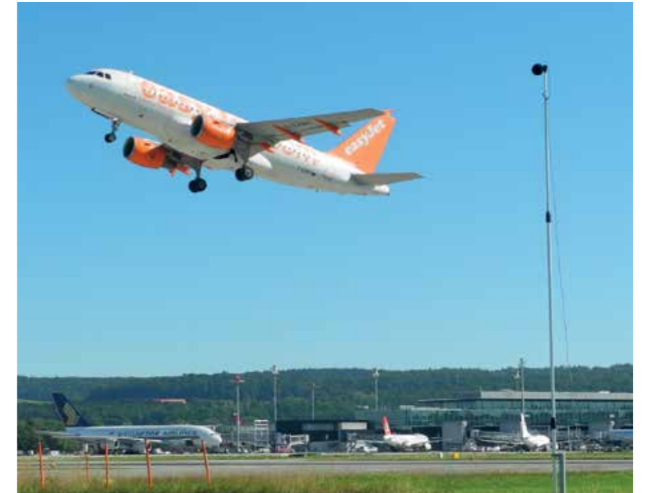
Die Empa will eine akustische Umwelt fördern, welche zu einer hohen Lebensqualität beiträgt, so zum Beispiel mit lärmarmen An- und Abflugverfahren. Rechts im Bild eines von acht Mikrofonen auf dem Flughafen Zürich zur Messung der Abstrahlcharakteristik von Flugzeugen.
